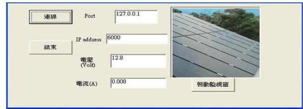
圖 5 太陽能發電暨蓄電系統的實體遠端 PC 之監控畫面
