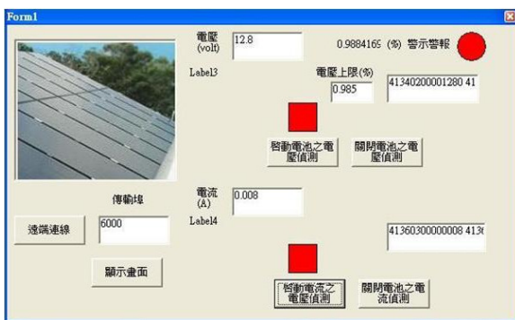
圖 4 太陽能發電暨蓄電系統的實體近端 PC 之監控畫面
